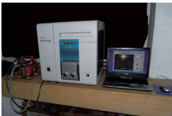
小型電子顕微鏡（卓上顕微鏡）。花粉や孢子、腺毛など植物の微細構造の観察に威力を発揮する
